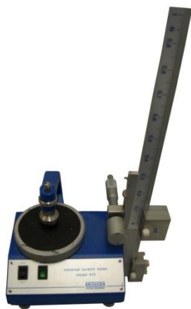
Рис. 10: Испытательный прибор для измерения устойчивости к вдавливанию
