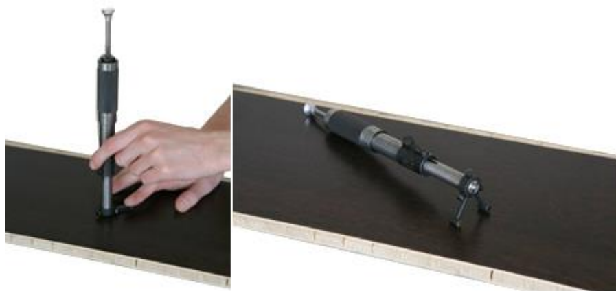
Рис. 11: Испытательный прибор с падающим шариком Рис. 12: Испытательный прибор с падающим шариком
