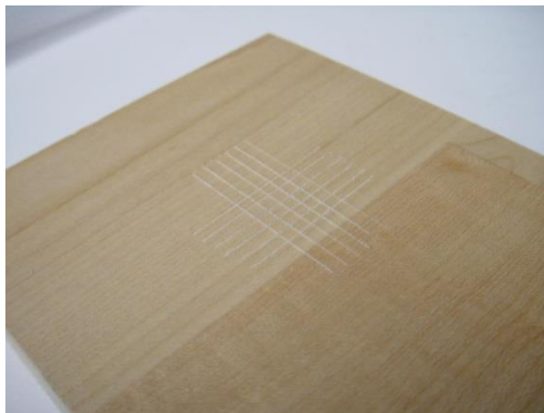
Рис. 5: Образец доски с решетчатым надрезом.
