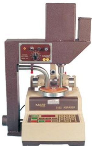
Рис. 17: Абразиметр Табера в устройстве для испытания падающим песком.
