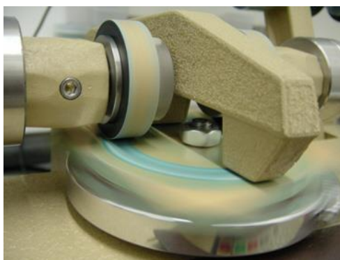
Рис. 16: Абразиметр Табера в движении
