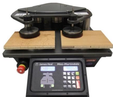
Рис. 19: Тестовый прибор Мартиндейла
