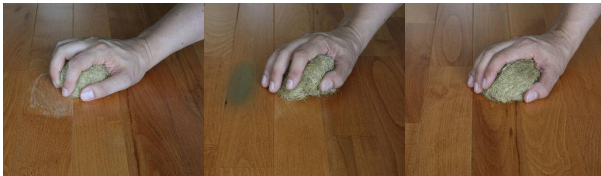
Рис. 7: Поверхностные царапины на поверхности, покрытой обычным покрывным УФ-лаком
