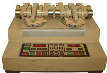
Рис. 15: Сдвоенная станция Абразиметр Табера
