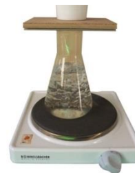
Рис. 21: Испытание горячим водяным паром
