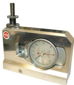
Рис. 3: Гамбергерский рубанок (Hamberger Nobel)
