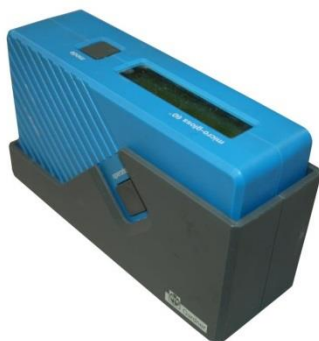
Рис. 6: Прибор для измерения степени глянца
